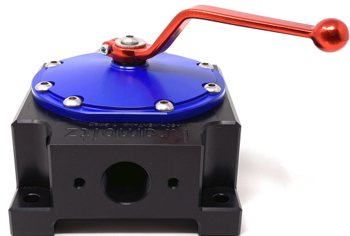
Anschlussbohrung saugseitig 1" mit BS-Gewinde und integrierter Eingangsfilterscheibe 25 µm und Befestigungsring
